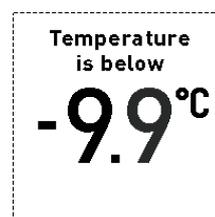
Le gel peut endommager le capteur. La température de fonctionnement recommandée du capteur est de 0 °C à 50 °C (32 °F à 122 °F).
